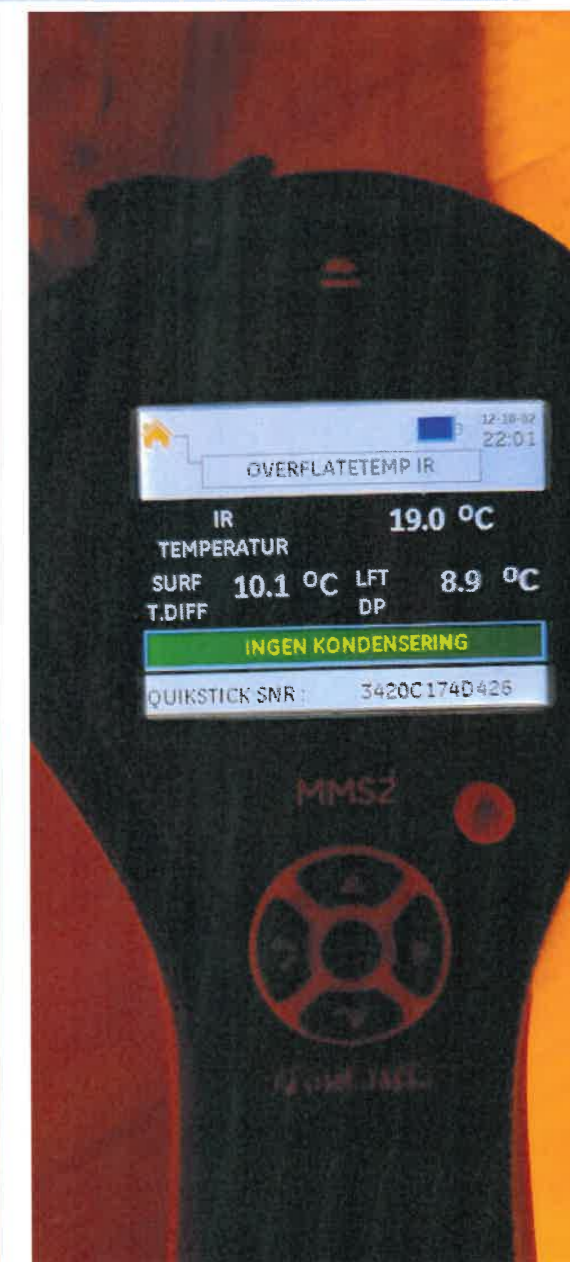
Bilde viser fuktmåler som viser ingen kondensering.
