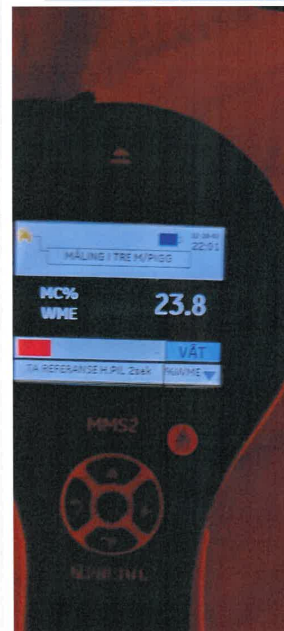
Bilde viser fuktmåler som viser våt.
