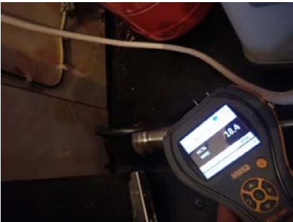
Måling i svill ved bereder.
