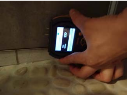
Fuktmåling i overgang gulv/vegg.
