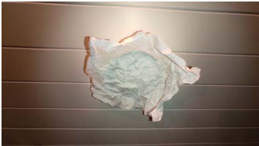
Test av avtrekket.
