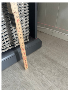
Måling med laser viste skjevheter på gulv.
