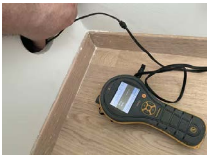
Hulltaking fra tilstøtende rom, målingen er utført i vegg bak dusjsone. Målingen viser ingen tegn til fukt i konstruksjonen.
