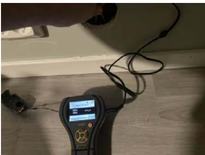
Hulltaking utført fra tilstøtende rom, målingen er utført i våtsonen. Målingen viser ingen tegn til fukt i konstruksjonen.
