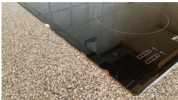
Skader i kanter på platetopp.
