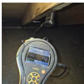
Synlige overflater (taktro, vegger, gulv, o.l) - Fuktmåling loft 2
