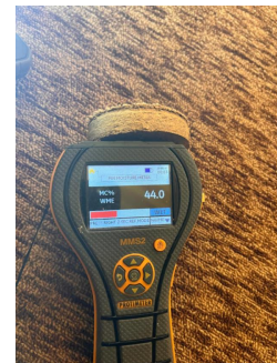
Fuktkontroll med pigger i veggplate som ble boret ut under trapp.
