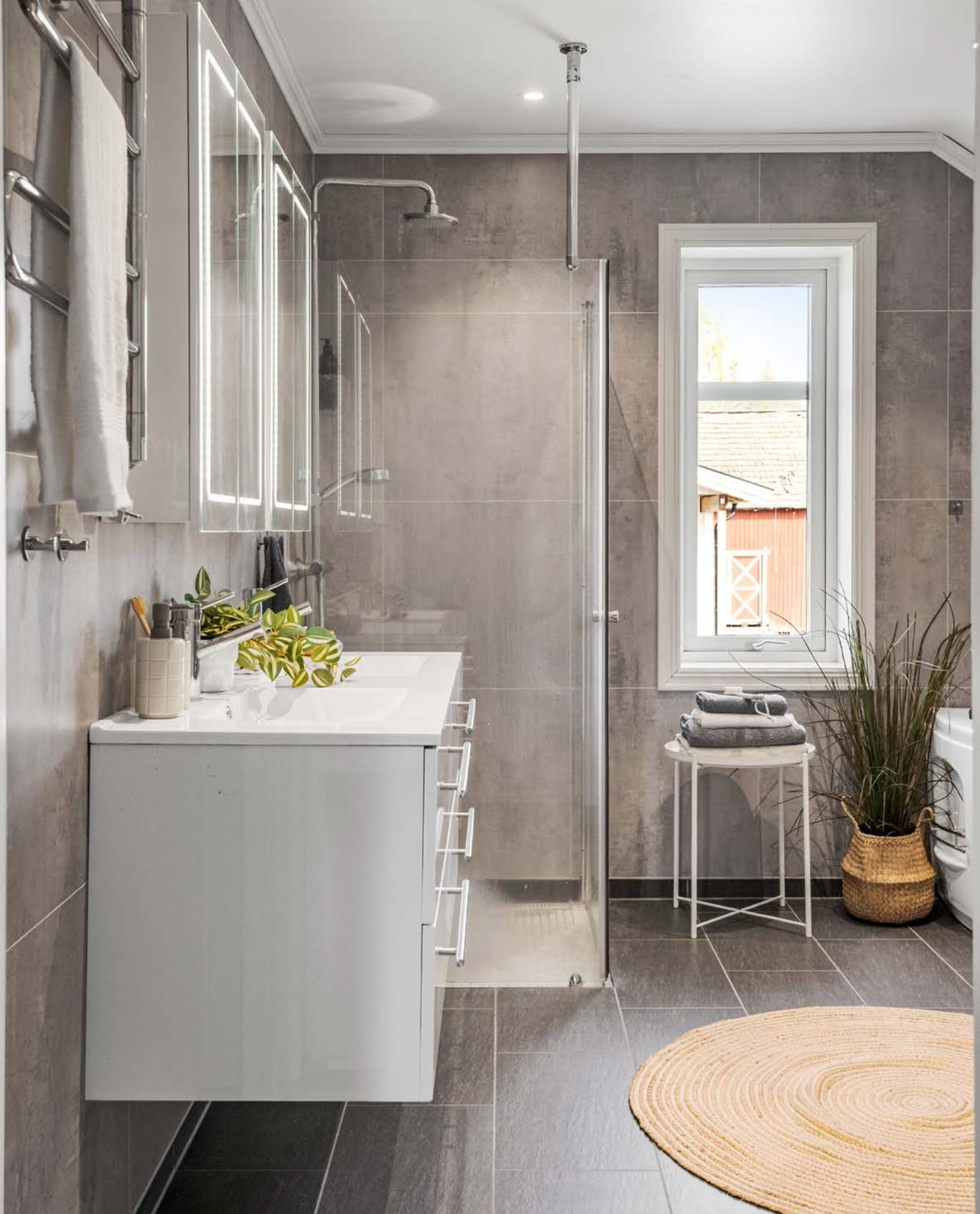
Stort og moderne baderom i 2. etasje fra byggeåret 2018. Badetrommet har mørke fliser på gulv, vannbåren gulvvarme, våtromsplater på veggene, downlights i himlingen og avtrekk via balansert ventilasjon.
