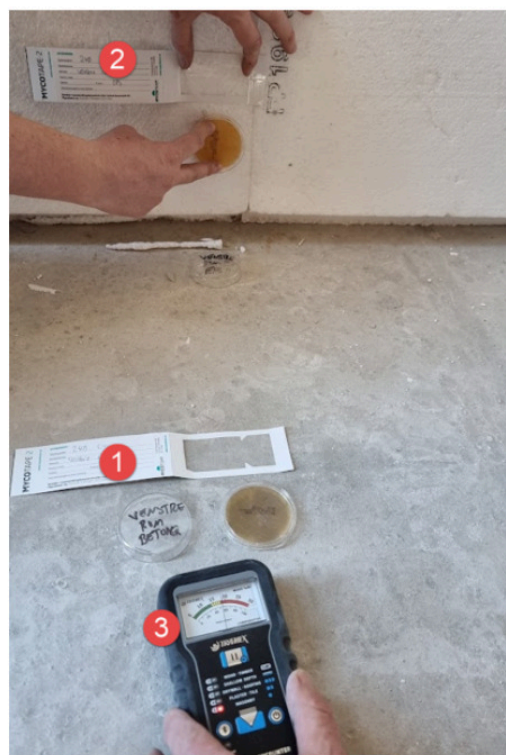
Foto 2. (Illustrasjonsfoto) Parkett og parkettunderlag er fjernet og DNA prøve tas av betongen (1) og undersiden av EPS (2). I dette illustrasjonsbildet er det også tatt dyrkningsprøver samtidig med DNA prøvene. Det er på forhånd gjort fuktsøk (3) slik at prøvene tas i områder med eventuelt forhøyet fuktutslag.
