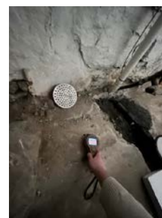
«Rødt» utslag på overflatefuktsøk
