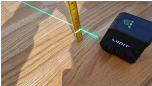
Kontroll av planavvik.
