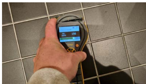
Det ble fuktmålt ved befaring, ingen forhøyde verdier ble registrert.
