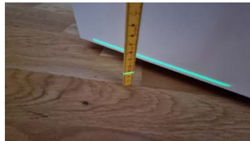
Kontroll av planavvik.
