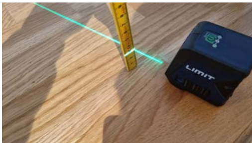
Kontroll av planavvik.
