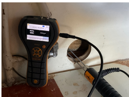
Fuktmåling i vegg ved hulltaking.
