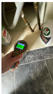
Fuktskjolder/svelling i bunnplate i benkeskap. Ved bruk av fuktindikator registrerte jeg ingen unormale verdier. Kjøkkeninnredning bærer preg av slitasje.
