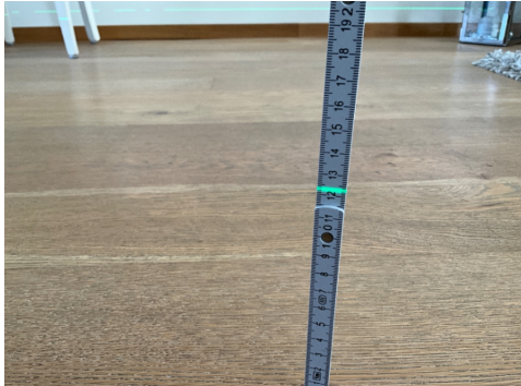
Utgangsstråle laser er 13,5 cm.
