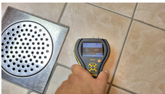
Det ble fuktmålt ved befarings, ingen unormale fuktverdier ble registrert.
