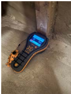
Saltutslag på vegg under trapp der eier har behandlet gulv/vegg.
