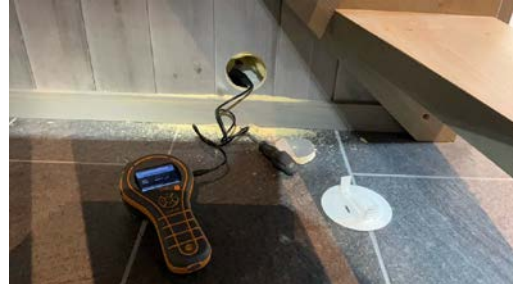
Hulltaking er utført i tilstøtende vegg mot dusjkabinett. Fuktmåling viste tørre verdier.
