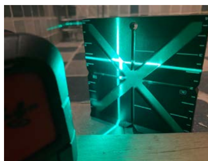
Måling av fall fra døråpning.
