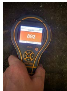
Fuktmåling med pigger i oppforet tregulv.
