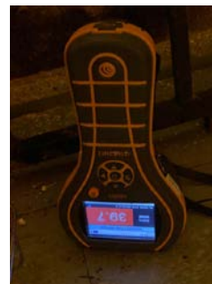
Fuktmåling med pigger i oppforet tregulv.
