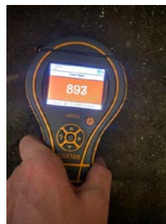
Fuktmåling med pigger i oppforet tregulv.
