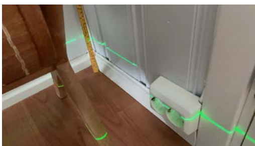
Målt høydeforskjell på soverom: 60mm.
