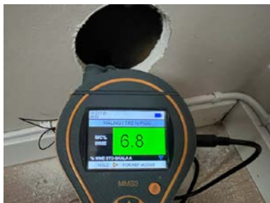
Hulltaking i tilstøtende soverom (bak dusjsone)
