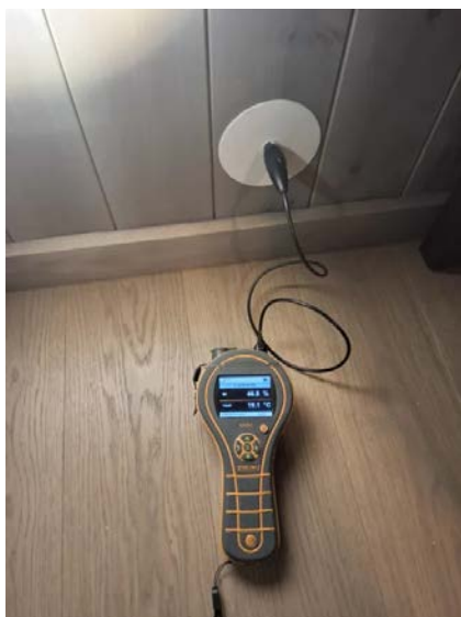
Bilde fra fuktmåling i veggkonstruksjon mot tilstøtende dusjsone.
