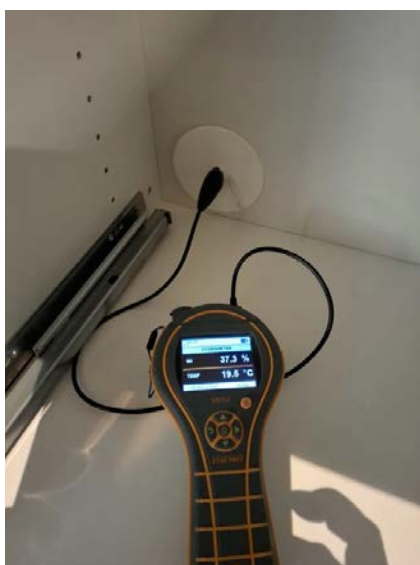
Bilde fra fuktmåling i veggkonstruksjon tilstøtende dusjsone.
