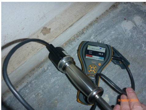
Fuktmåling delevegg mellom boder i vest, 48,8 %
