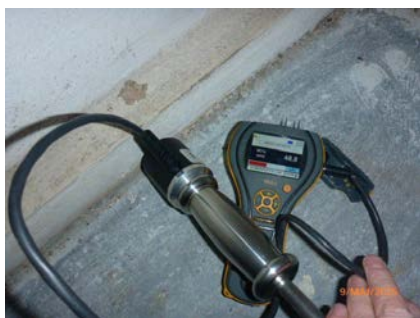
Fuktmåling delevegg mellom boder i vest, 48,8 %
