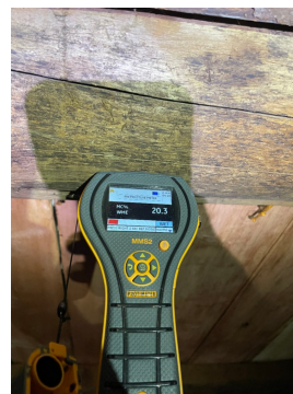
Det måles fukt i treverk med ytterligere skadepotensiale.
