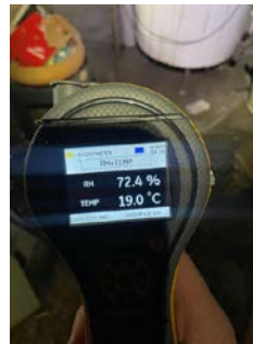
Det måles høy luftfuktighet i kjellerrom.
