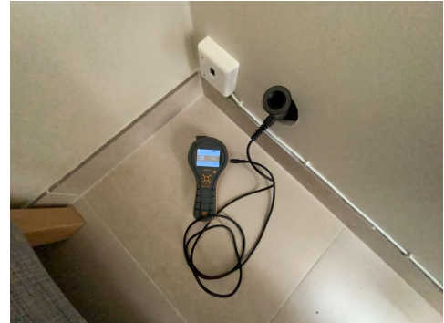
Utført hulltaking på rom under terreng.
