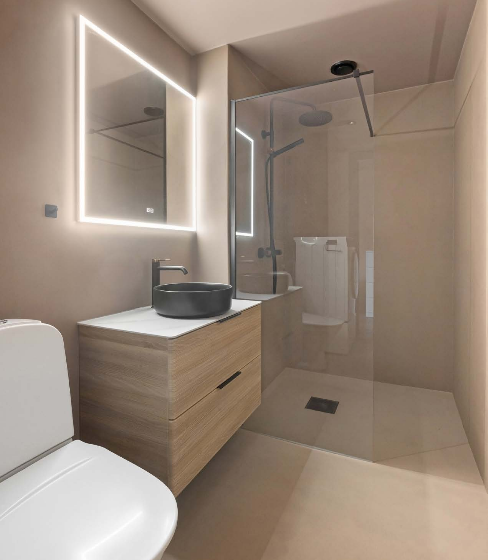
Bad med microsement på gulv og vegger, samt gulvvarme. Badet er innredet med servant i baderomsinnrending, speil med integrert belysning, dusjhjørne med glassvegg og toalett.
