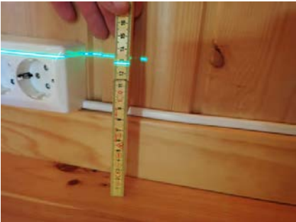
Referansenivå laser = 4 cm. Viser høydeforskjell på ca. 9 cm fra stue ut til yttervegg i spisestue.
