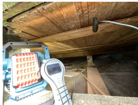
Utført fuktmåling på trevirke mot grunnmur. Moderat fuktprosent på befaringsdagen.
