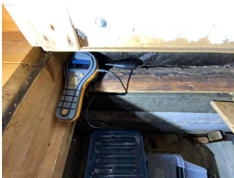
Utført fuktmåling på trevirke mot grunnmur. moderat fuktprosent på befaringsdagen.
