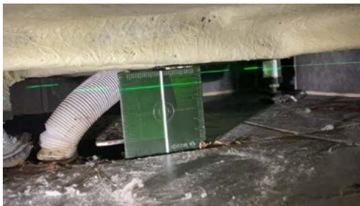
Målt fall til sluk: 13mm.
