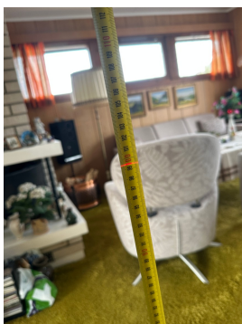
Målt avvik. gjennom rommet: 6mm
