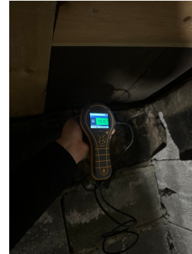
Fuktmåling ved svill med fukt forringelse.
