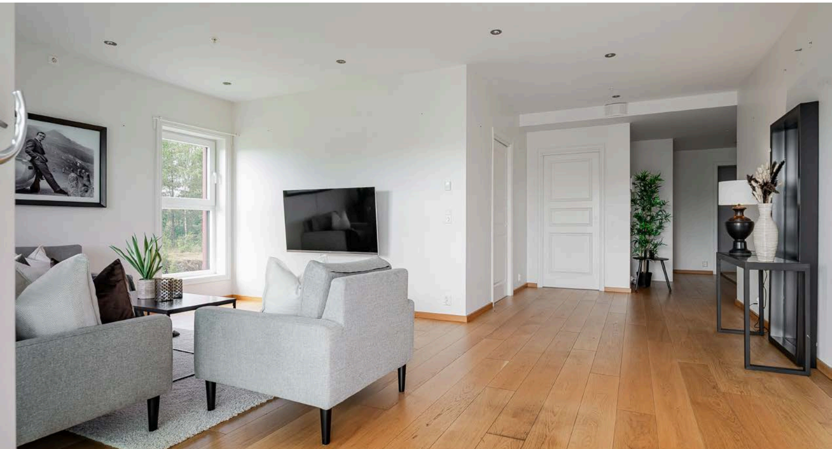
God og moderne standard fra 2018 med enstavs parkett på gulv, vannbåren gulvvarme tilknyttet fjernvarme, glatte lysmalte overflater, skjult elektrisk anlegg og downlights i himlingen.
