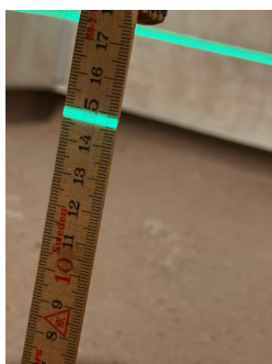
12-13mm høyde på membran under dørterskel
