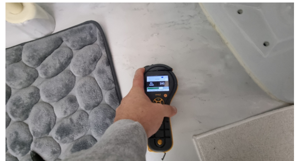
Det ble fuktmålt ved befaring, ingen unormale fuktverdier ble registrert.
