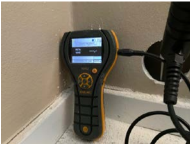
Fuktmåling i vegg ved hulltaking.
