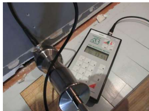
Foto 39. Fuktmåling inn i gipsplate/bunnsvill inn i ytterveggen ved lekkasjeområdet. Tørt ved inspeksjonen (13,5 vekt% trefukt).
