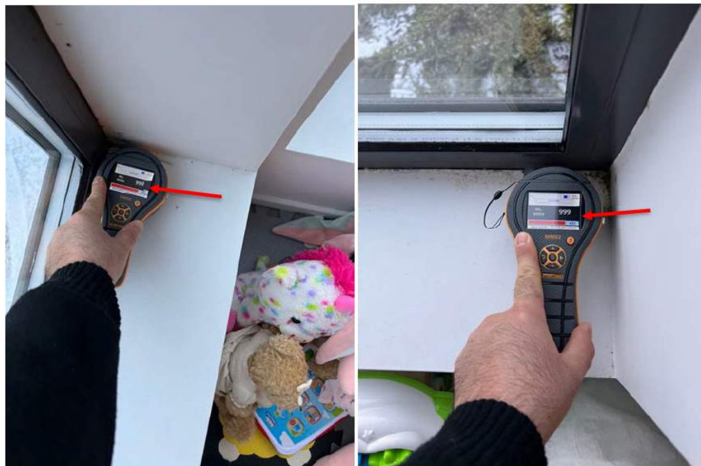
Piler på bilder over viser at det er fullt utslag på fukt i vinduskarmer.
