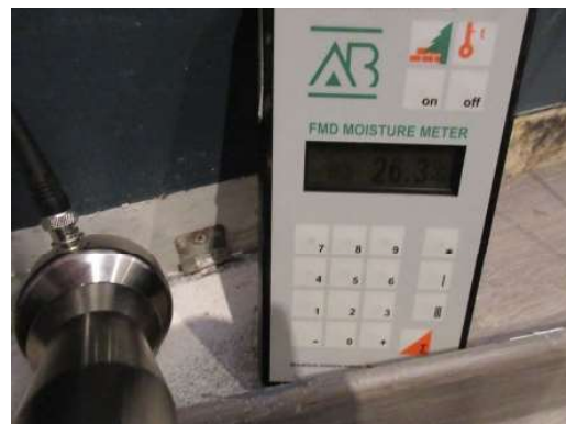
Foto 14. Høy fuktighet (26,3 vekt% trefukt) målt inn i gips/bunnsvill på langvegg bak seng.
