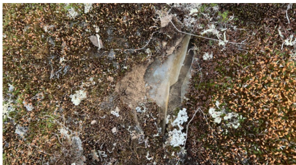
Skade i plastunderlaget
