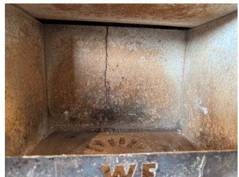
Sprekk i ildfast stein inni peisovn.
