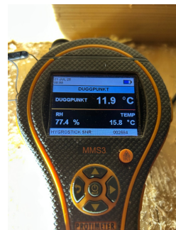
Måling av relativ luftfuktighet i lukket veggkonstruksjon i kjølerom i kjeller.
