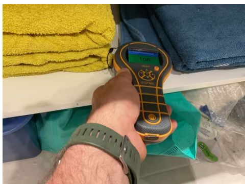
Ingen indikasjon på fuktighet
