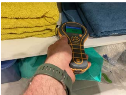
Ingen indikasjon på fuktighet
