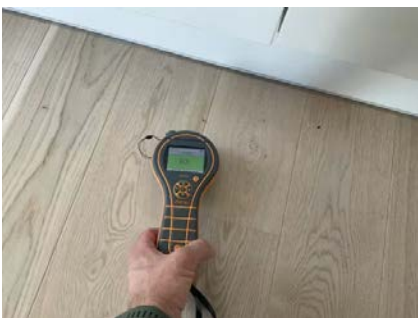
Ingen indkasjon på fuktighet
