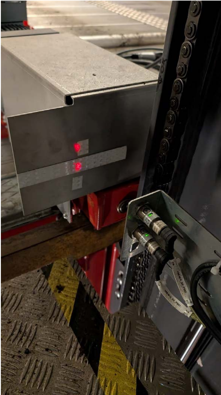
Foto 50: Endepunkt sensor for plattform øvre nivå
