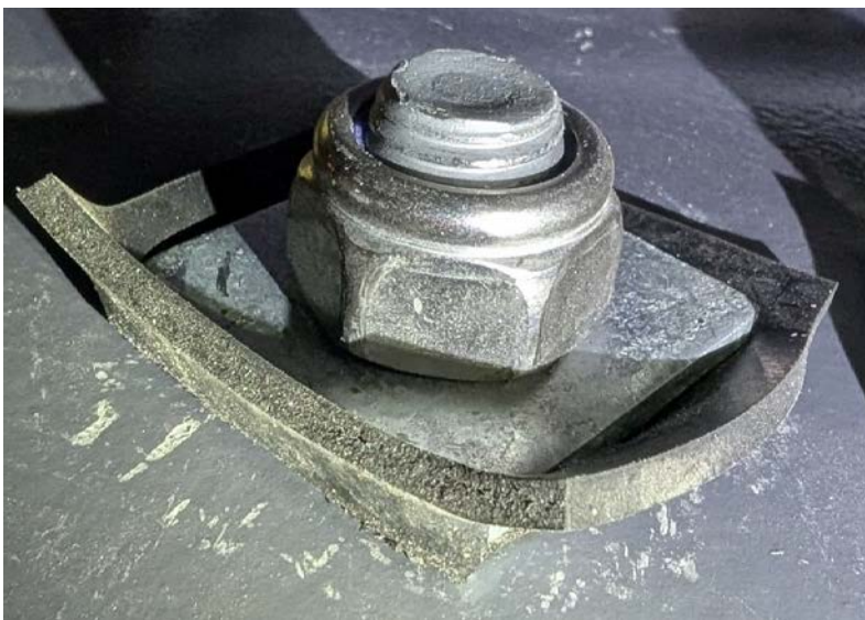
Foto 19: Komprimert gummi i forbindelse, BK1
