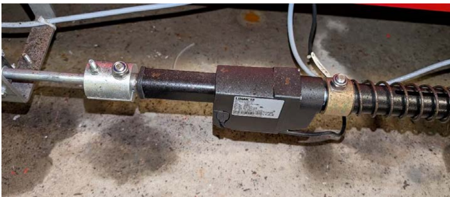
Foto 38: Elektrisk aktuator for låsebolter 300N/2
