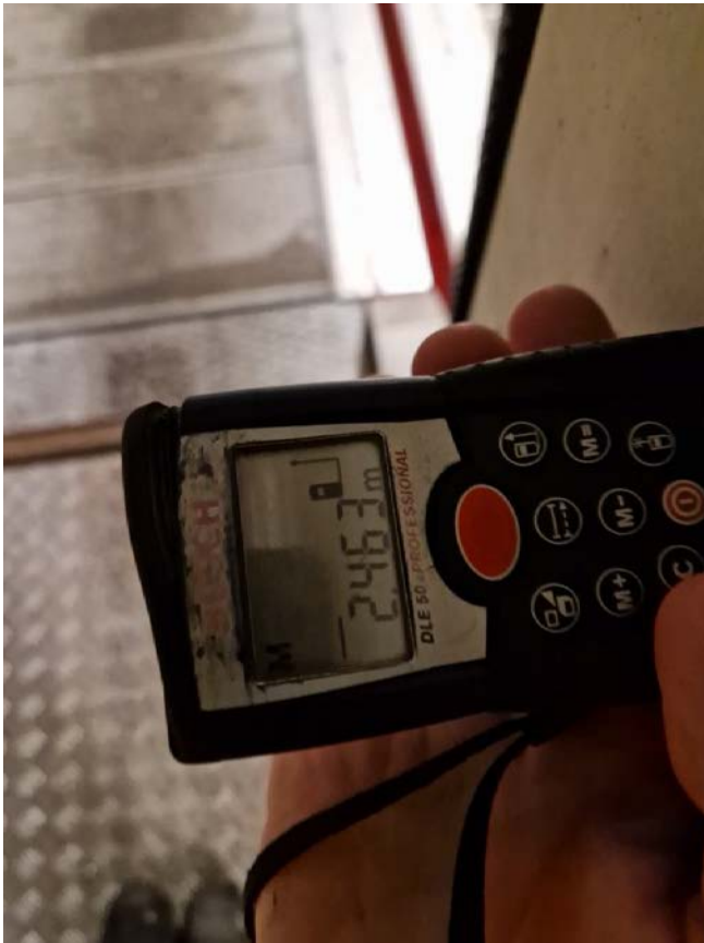
Foto 51: Målt bredde innkjøring
