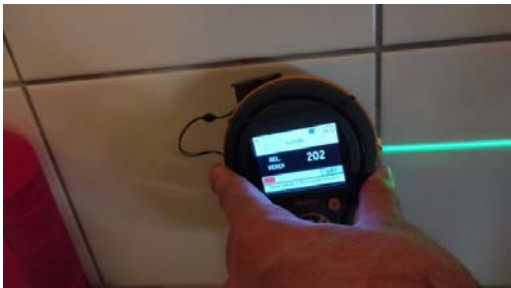
Fuktsøk på vegg.
