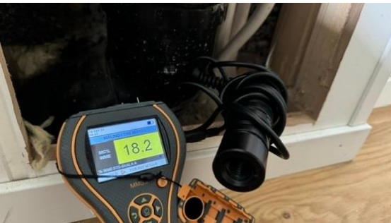
Bilde viser måling med pigg i inspeksjonsluke i rom mot terreng.
