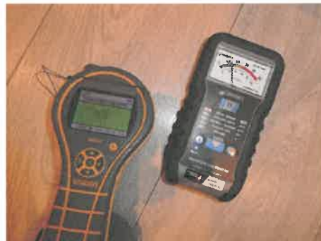
Fuktmåling på kjøkkengulv ETASJE > KJØKKEN
