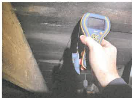
Måler 47 vektprosent fukt i taktro
