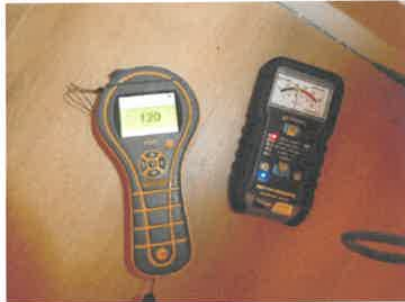
Fuktmåling på kjøkkengulv
